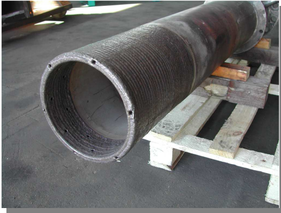
Sanierung einer Beschickungslanze in einer Sondermüllverbrennung - Beschichtung mit einem speziellen Werkstoff, korrosions- u. hitzebeständig
