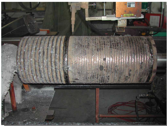
Hartauftrag mit speziellem Werkstoff, Walze für Glasrecyclinganlage
