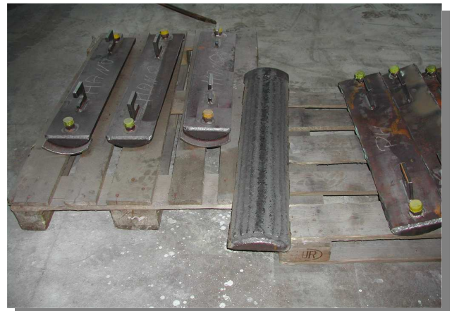
Auftragschweißen von Rostabdeckungen in Müllverbrennungsanlagen
